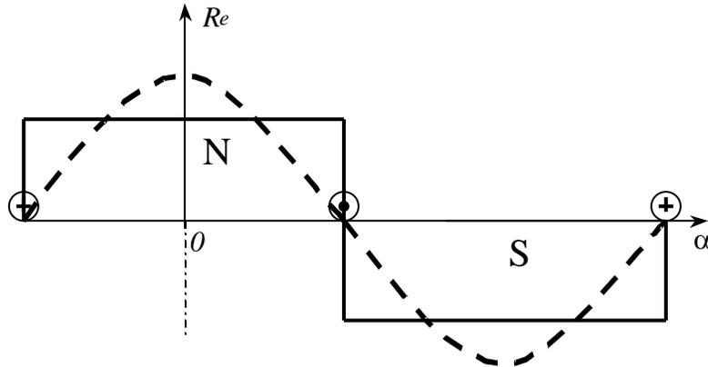
Figura 2-3 Andamento qualitativo della forza magnetomotrice al traferro – avvolgimenti concentrati
