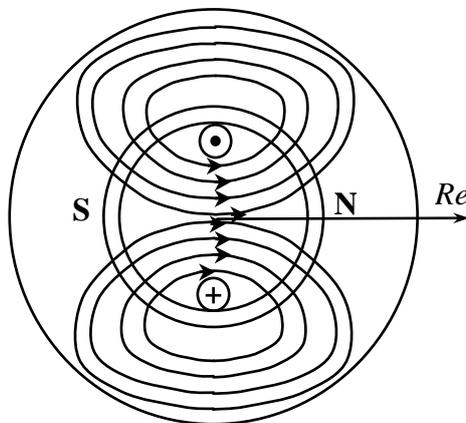
Figura 2-1 Macchina isotropa con rotore alimentato – avvolgimenti concentrati
