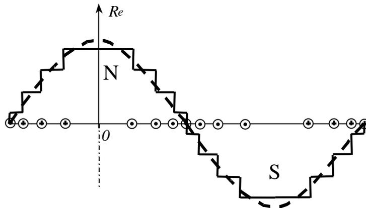
Figura 2-4 Andamento qualitativo della forza magnetomotrice al traferro – avvolgimenti distribuiti sinusoidalmente
