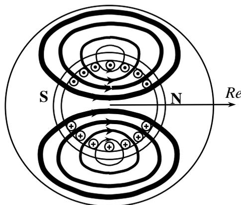
Figura 2-2 Macchina isotropa con rotore alimentato – avvolgimenti distribuiti
