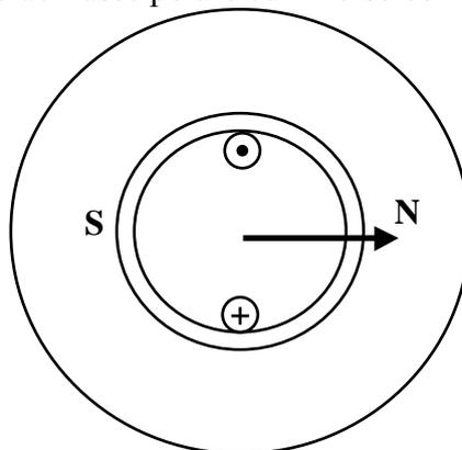
Figura 2-5: Rappresentazione della fmm mediante fasore spaziale
